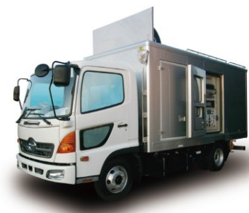
電源車 (出典：明電舎HP)
