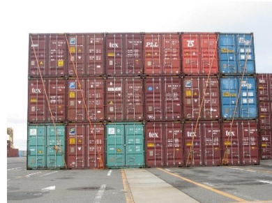
写真 3.2.4 ラッシングベルトによる固定
