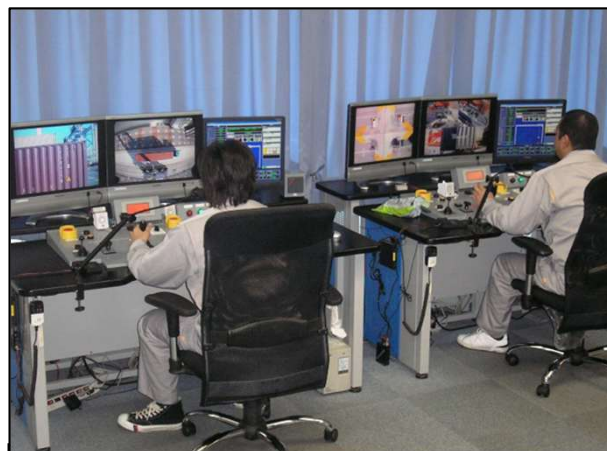
遠隔自働RTGとトレーラーの遠隔操作
