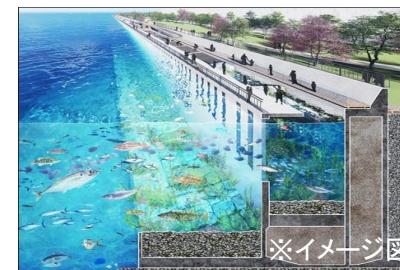
【生物共生型港湾構造物】
