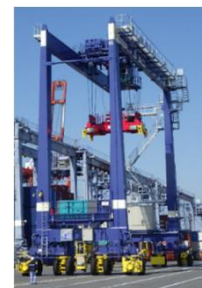
遠隔操作化RTG
