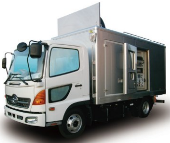
電源車 (出典：明電舎HP)
