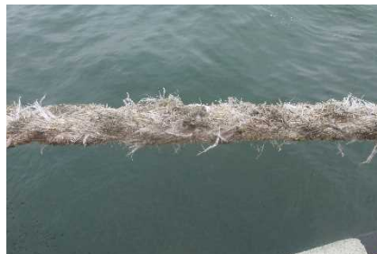
劣化してほつれた係船ロープ
