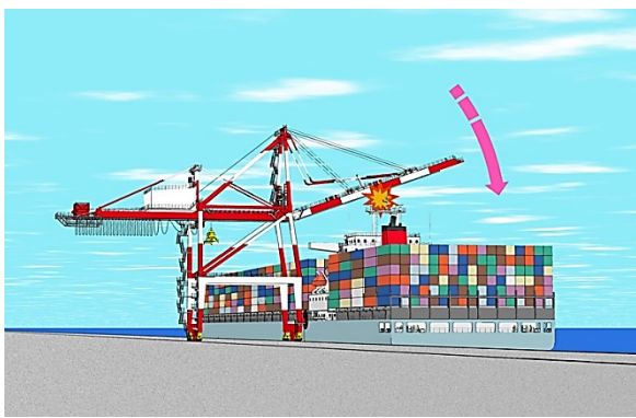
クレーンと船橋との衝突(起伏時)
