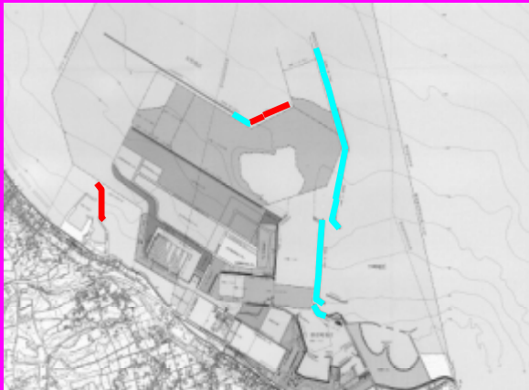
地震動による防波堤破壊
