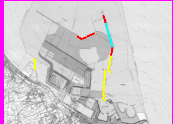
液状化による防波堤破壊
