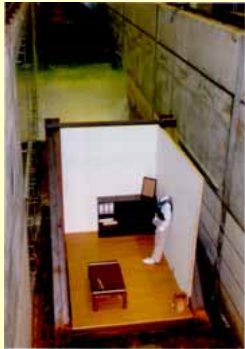
大規模波動地盤総合水路による木造家屋壁破壊実験
