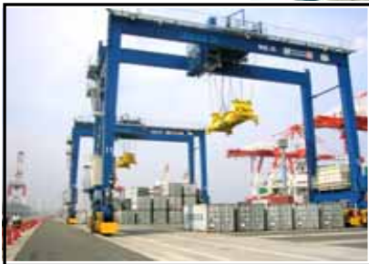
トランスファークレーン
