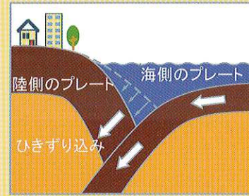
海側のプレート*により、陸側プレートが引きずりこまれ、陸側のプレートが元の位置にもどろうとして跳ね上がったときに生じるゆれが地震です。
