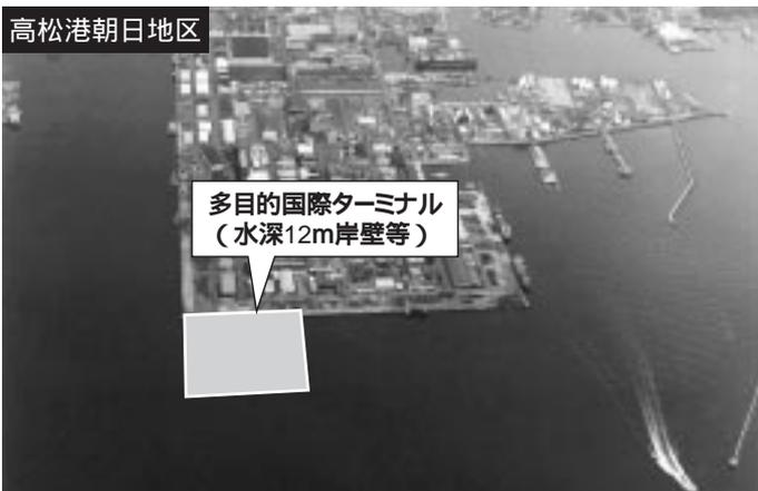
高松港に多目的国際ターミナル(耐震)を整備することにより、南海地震等の大規模地震発生時に緊急物資輸送拠点として機能するとともに、3万DWT級大型船の入港が可能となるなど、物流コストが削減される。
