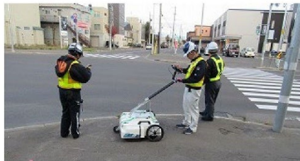
【写真】 高精度地中探査電磁波レーダー式（カート型）
