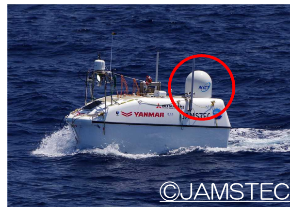
無人洋上中継器 (ASV) (全長4m, 幅2m, 最大5ノット)
