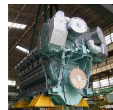
新型軸流過給機搭載主機関
