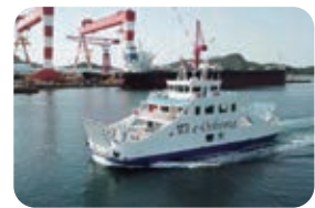
▲完全バッテリー駆動式自動運航船 (e-Oshima)
