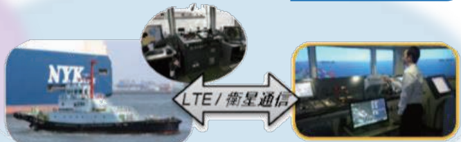
400km離れた陸上施設から遠隔操船機能を実証
