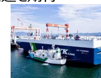
LNGバンカリングの様子
