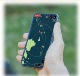
AISと同様の機能を有するスマートフォン向けアプリケーションが、リリースされています。スマートフォンアプリは、AIS機器の導入が難しい小型漁船(船外機船等)でも利用可能！
