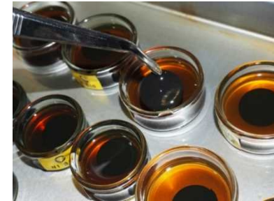
ゴム材料の浸漬試験
