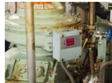
燃料清浄試験時の燃料油の設定温度
