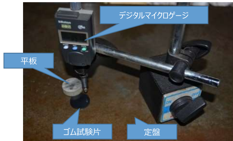
ゴム試験片の寸法計測
