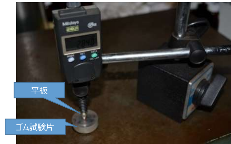
ゴム試験片の寸法計測
