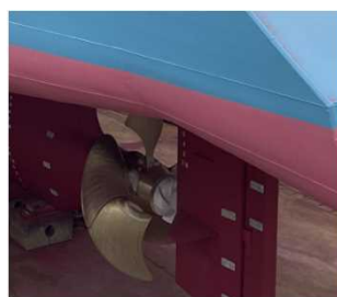
5翼可変ピッチプロペラ、エコキャップ、旋回流回収型舵
