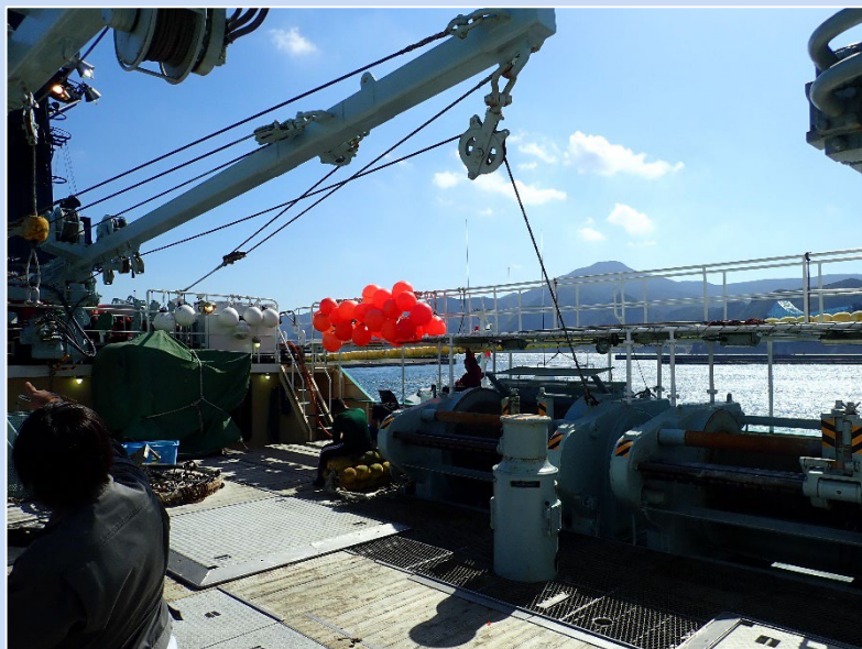
甲板上に設置された漁ろう装置
