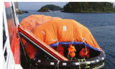
荒天下の乗り移り時の落水を防止するスライダー付き救命いかだ（大型船用）の例 出典：Survitec
