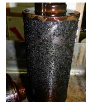
フィルターへのスラッジの付着
