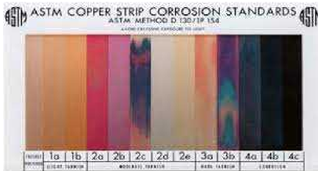
銅ストリップ試験による石油製品からの銅に対する腐食性の標準試験法
