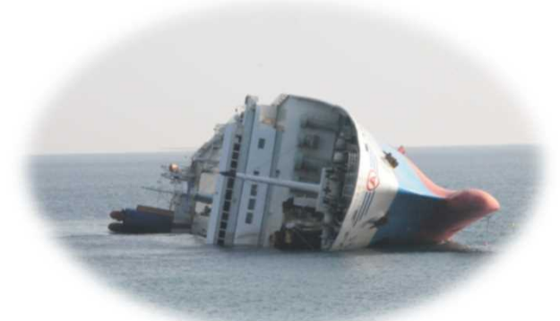
復原力喪失現象による大傾斜
