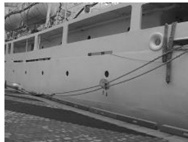
写真13 Aft Spring Lines
