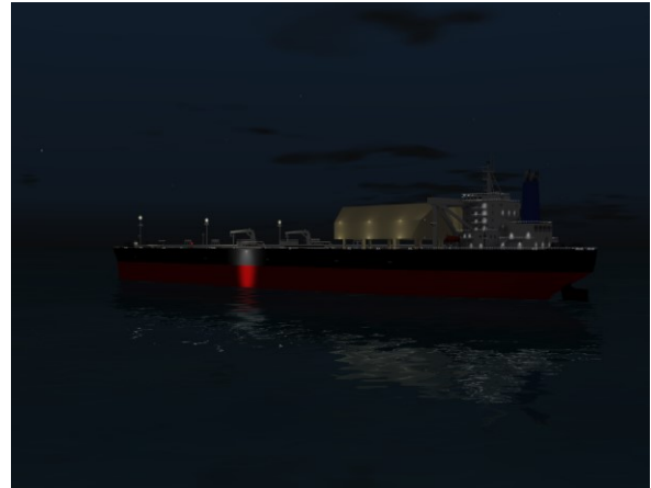
図 1.2 外景（夜間） デッキ上の照明＋舷側照明 1 か所 （照明具合：暗め）
