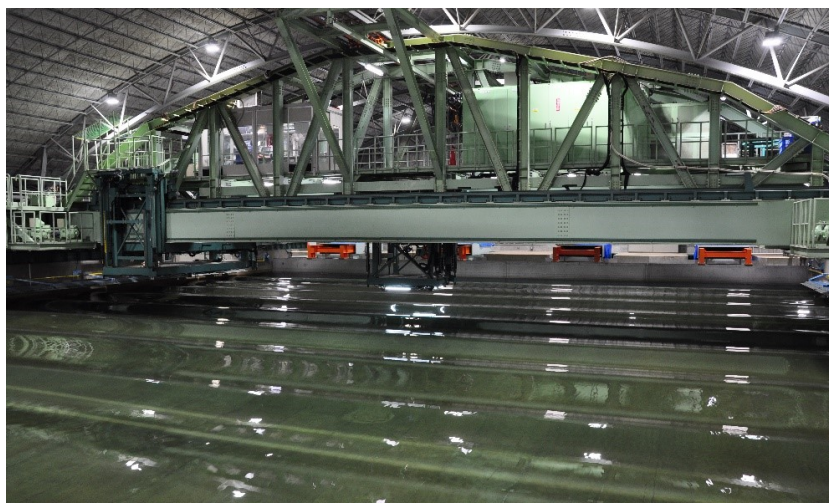
図 3.1 海洋構造物試験水槽で造波中の様子
