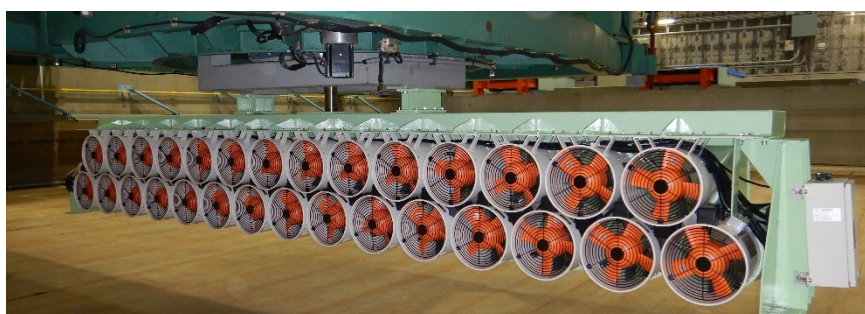
図 3.2 多連式ファンによる風発生装置
