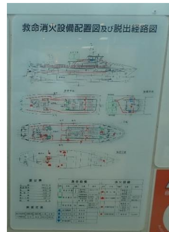
救命消火設備配置図の例 ▶
