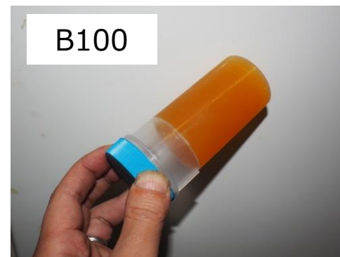
低温条件下におけるSVO-LSA混合油（約0℃）
