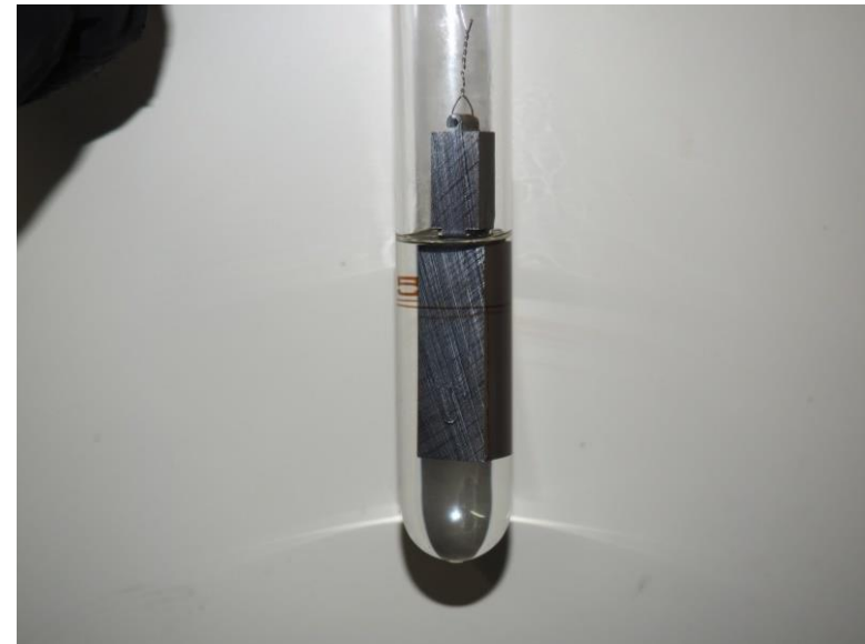
鉄鋼材料腐食試験の様子
