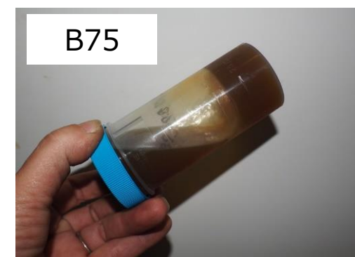
低温条件下におけるSVO-LSA混合油（約0℃）
