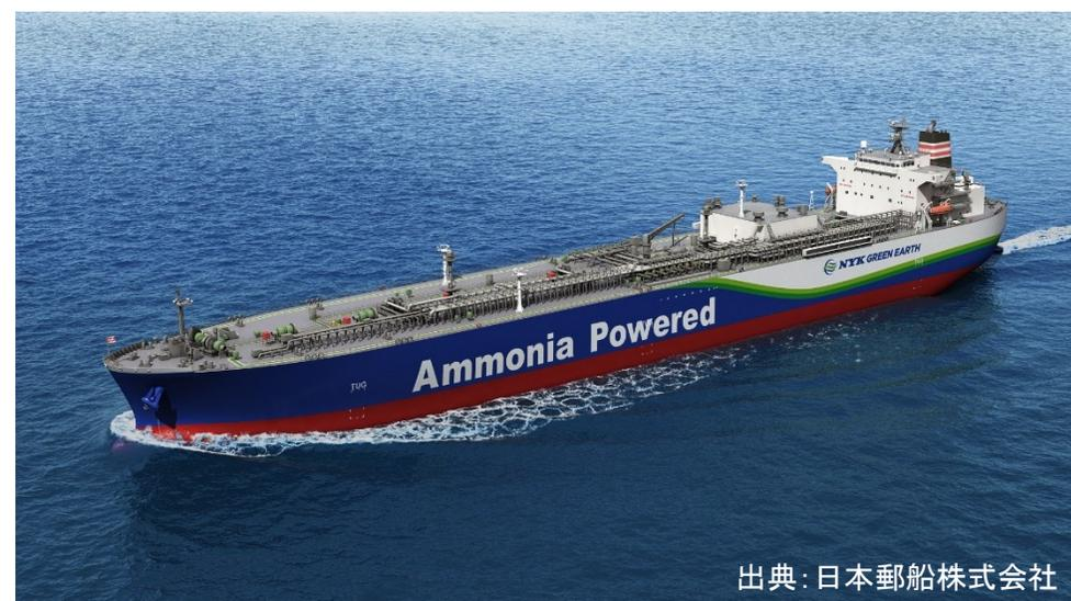
船種 : 40000m<sup>3</sup>型アンモニア燃料アンモニア輸送船
