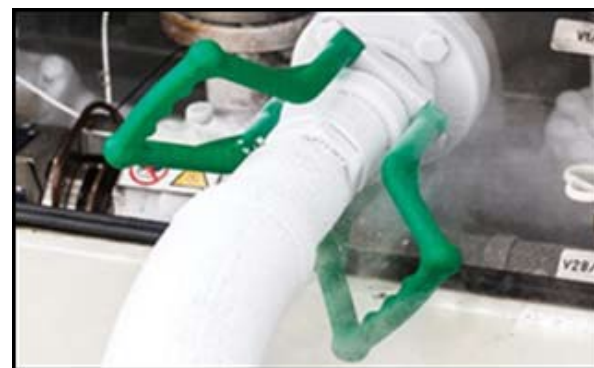
LNGバンカリング接続機器
