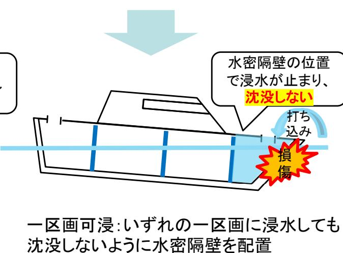
一区画可浸: いずれの一区画に浸水しても沈没しないように水密隔壁を配置
