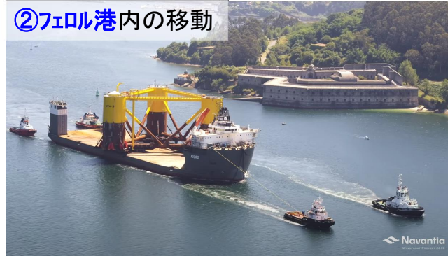
②フェロル港内の移動 ・フェロル港のナバンティア社ヤードで製作した浮体基礎はセミサブ船でフェロル港サンシブラオ地区へ移動
