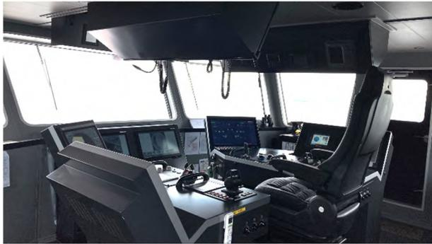
操船性能の向上、効率化を目的としたインテグレートブリッジシステムは機器を集約することで、1人で操船作業可能な配置となっている
