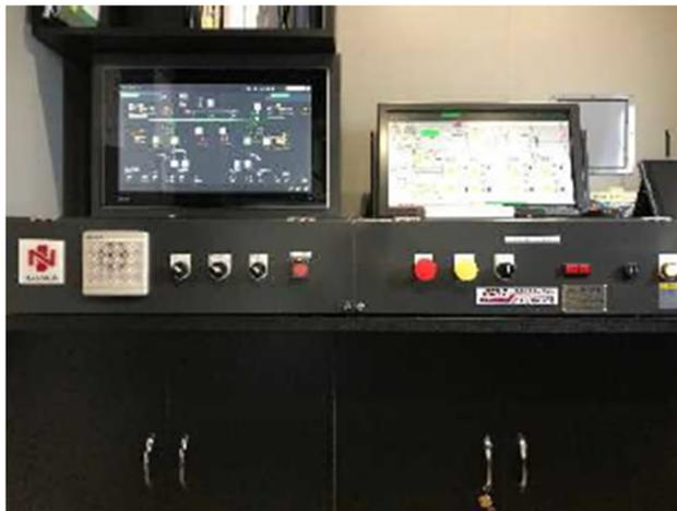
本船クラスの内航タンカーとしては初めてとなる自動荷役システムを搭載しており、このシステムは防爆タブレットを使用した遠隔操作が可能で、これは内航タンカーとして初めてとなる。
