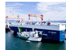
LNGバンカリングの様子
