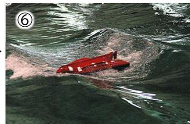
左斜め追波を航走中で波乗り状態となり、最大舵角の右舵を取ったにも関わらず左回頭が発達して(ブローチング現象)転覆した例。
