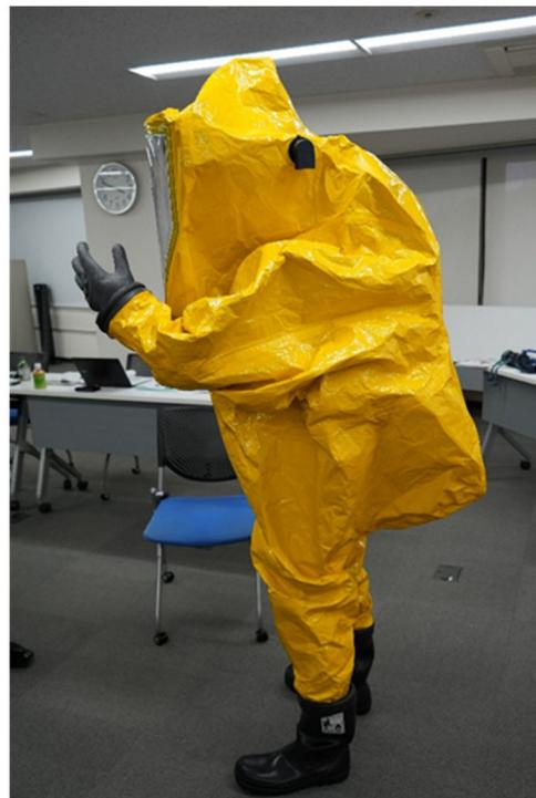
自蔵式呼吸具・気密服（自蔵式呼吸具を服内に装着する気密服）の着用例
