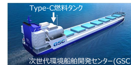
次世代環境船舶開発センター(GSC) アンモニア燃料船イメージ
