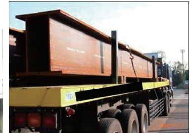
幅広厚板輸送 (傾動車両)
