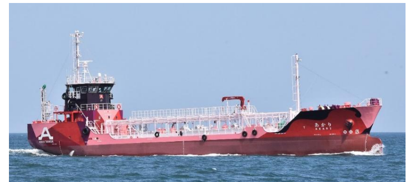
ピュアバッテリー電気推進タンカー「あかり」
