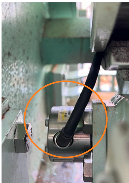
ピン型ロードセルをブレーキに内蔵
