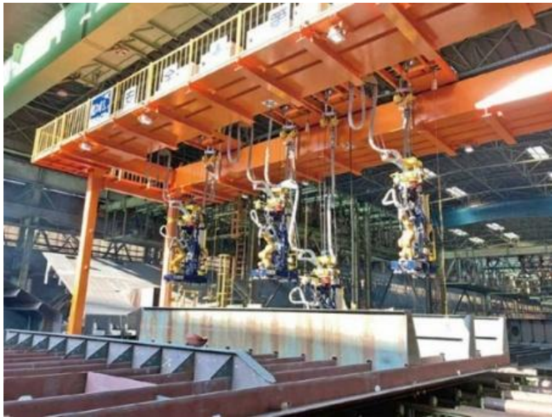
自動溶接ロボット
