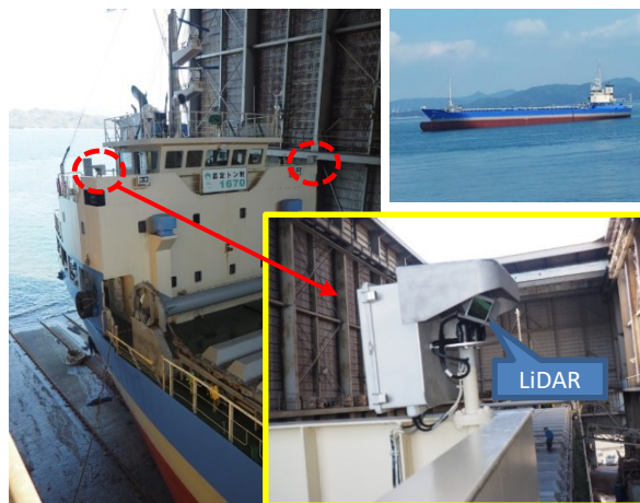
LiDARシステムの搭載（みやび丸）
