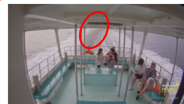
後部甲板(排気色に異常が発生)
