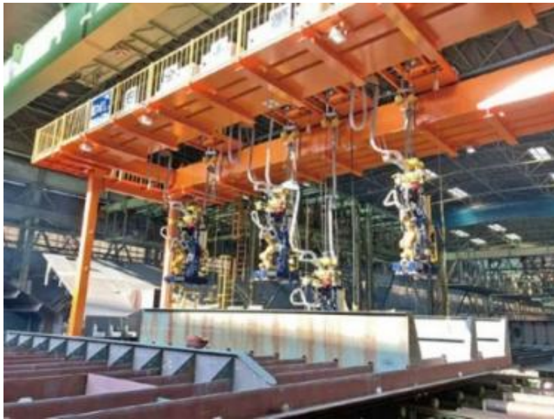
自動溶接ロボット
