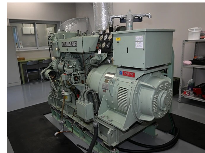
タグボート“魁”に搭載されていた発電機を再利用したテスト・エンジン(当社HPより)
